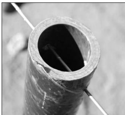
Foto N°8. Caño petrolero de fibra de cetrón, de 2,3/8 pulgadas, resistente, ignifugo y no se necesitan aisladores.
