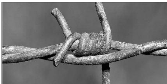
Foto N°3. Alambre de púas.
